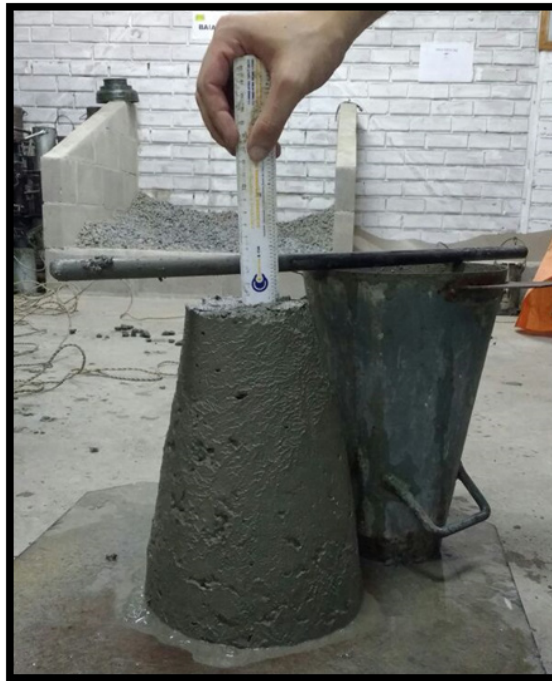
Figura 2: Ensaio de consistência do concreto - slump test.
